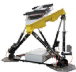
La tavola di simulazione elettrica prevista per l'uomo, con la piattaforma Stewart di dimensioni ridotte, incorpora attuatori elettrici che offrono movimento a sei gradi di libertà (ovvero in qualunque direzione nello spazio). Il controller di test riproduce spettri di vibrazione o cronologie temporali per fornire un controllo preciso per la valutazione del comfort.
