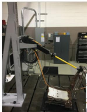
Sistemi di test di fatica per sedili
