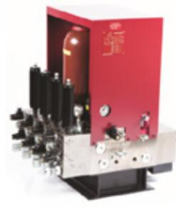
I moduli idraulici di servizio (HSM) Moog forniscono pressione idraulica on/off con una transizione regolabile da pressione non attiva a elevata. I filtri proteggono le delicate servovalvole e gli accumulatori forniscono un flusso immediato o uno smorzamento della pressione quando necessario. Sono disponibili numerosi valori di portata con 1-4 opzioni per stazione.
