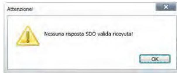
La causa potrebbe essere il buffer del PC non vuoto; riprovare e se non si ottiene comunque la comunicazione, controllare per prima cosa lo stato del cavo di connessione
