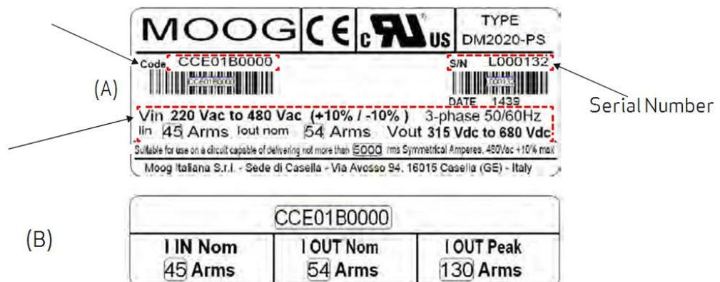
Fig 2.2 Esempio di targhetta alimentatore laterale (A) e frontale (B)
