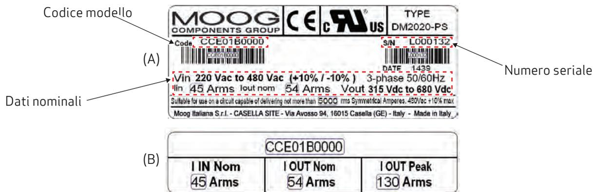
Fig 2.2 Esempio di targhetta alimentatore laterale (A) e frontale (B)
