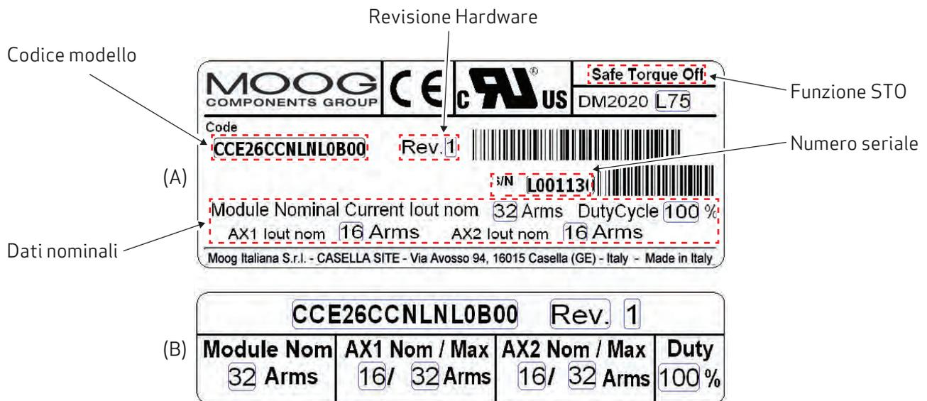
Fig 2.4 Esempio di targhetta modulo asse laterale (A) e frontale (B)
