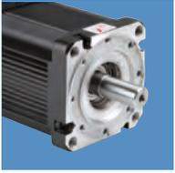
Il servomotore Moog serie Fastact H (W) è un motore sincrono a magneti permanenti caratterizzato da compattezza, altissima sovraccaricabilità e da elevate accelerazioni. È disponibile in una vasta gamma di taglie, con coppie nominali da 0,3 Nm a 831 Nm e coppie di picco da 1,8 Nm a 1721 Nm, con raffreddamento naturale (Fastact H) o a liquido (Fastact WH).
