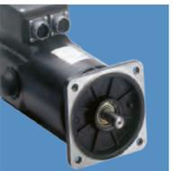
I servomotori C.C., serie ISM ed i motori C.C. per usi universali serie 407 con eccitazione a magnete permanente, sono disponibili in due taglie per ciascuna serie (coppia pari a 1 e 2 Nm), con una vasta gamma di avvolgimenti, per tensioni di alimentazione da 12 a 200 Vcc, sono particolarmente adatti per funzionare, associati a regolatori elettronici, in un'ampia scala di velocità in regime di coppia costante.
