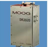
Il DR2020 è un azionamento adatto ad applicazioni con elettronica distribuita sulla macchina, integrabile all'interno di una configurazione multiasse. Grazie alla protezione IP67, il DR2020 non richiede l'installazione all'interno di un armadio elettrico, ma può essere posizionato a bordo macchina con una conseguente razionalizzazione dei cablaggi e riduzione dell'ingombro del quadro elettrico, grazie anche all'impiego di un connettore unico potenza/segnale.
