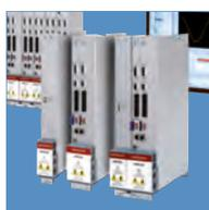
Compatto e flessibile, il DM2020 è un azionamento multiasse modulare con alimentazione centralizzata. È equipaggiato da Bus di campo (EtherCAT, CANBus) e gestisce motori sincroni a magneti permanenti, motori lineari, motori coppia, e motori asincroni. Le taglie di corrente vanno da 2 a 128 Arms nominali e fino a 256 Arms di picco.
